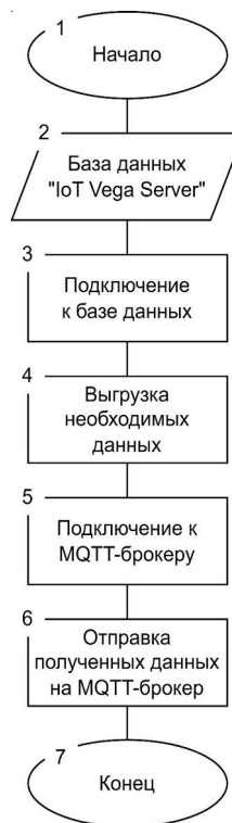
Рис. 5. Блок-схема алгоритма интеграции Vega BC 1.2 в IoT-систему на базе протокола MQTT
