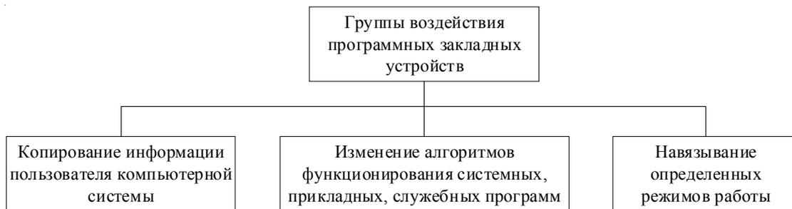
Рис. 2. Группы воздействия программных закладных устройств
