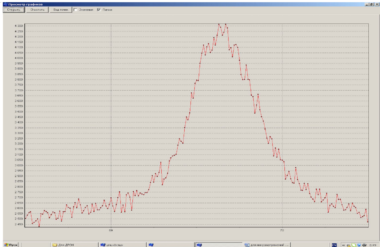
Рис. 3. Фрагмент дифрактограммы образца из ниобиевого сплава 5 ВМЦ, после насыщения азотом 800° – 10 ч и отжигов 1,5 ч – 1000 °С и 1 ч – 1200 °С. Линия (211)_\alpha
