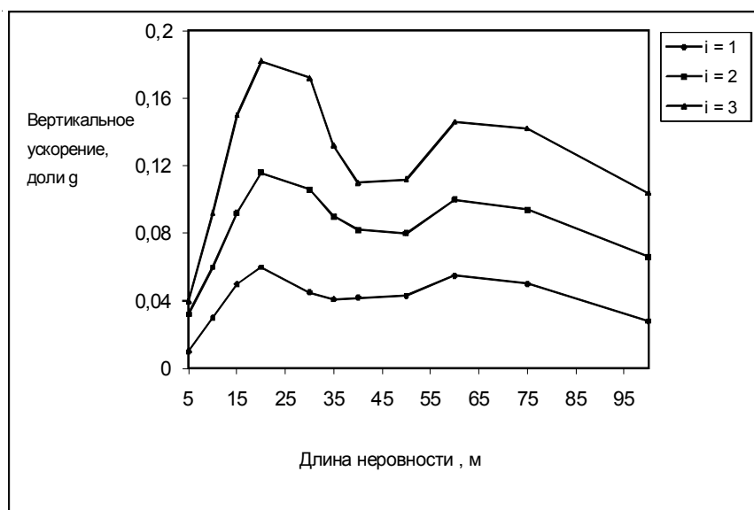
Рис. 1 Вертикальное ускорение центра кузова скоростного экипажа при прохождении изолированных неровностей со скоростью 200 км/ч
