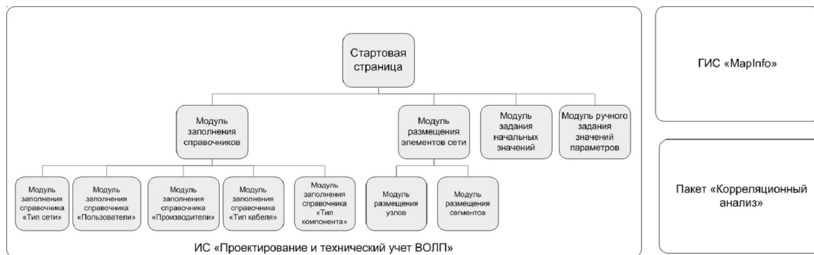
Рис. 4. Модель пользовательского интерфейса ИС «Проектирование и технический учет ВОЛП»
