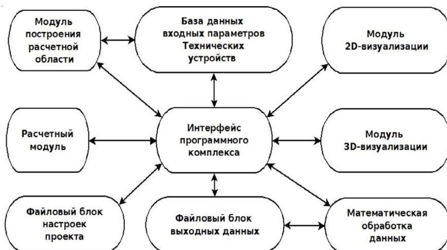
Рис. 1. Схема, отражающая принцип и структуру работы программного комплекса; стрелками указаны направления потока данных
