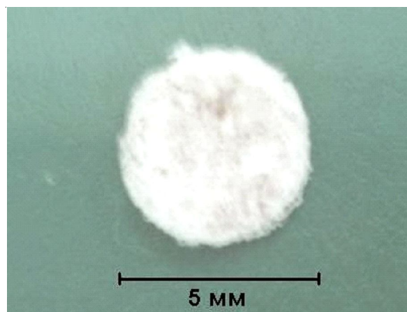
Рис. 2. Внешний вид скаффолда из пористого хитозана
