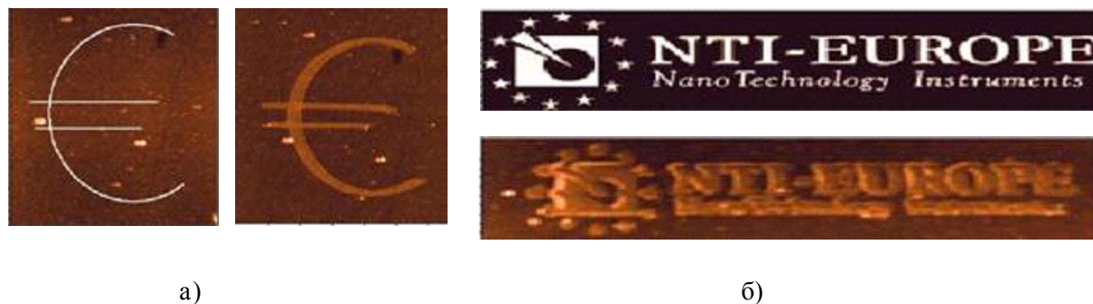
Рис. 3. Примеры векторной (а) и растровой (б) АСМ-литографии (изображение получено с помощью методики локального зондового электрического окисления на GaAs пленке)
